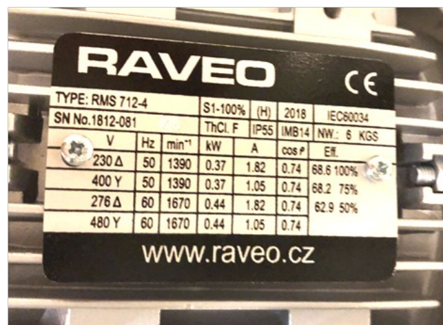
Obr. 26 - Štítek motoru dopravníku
